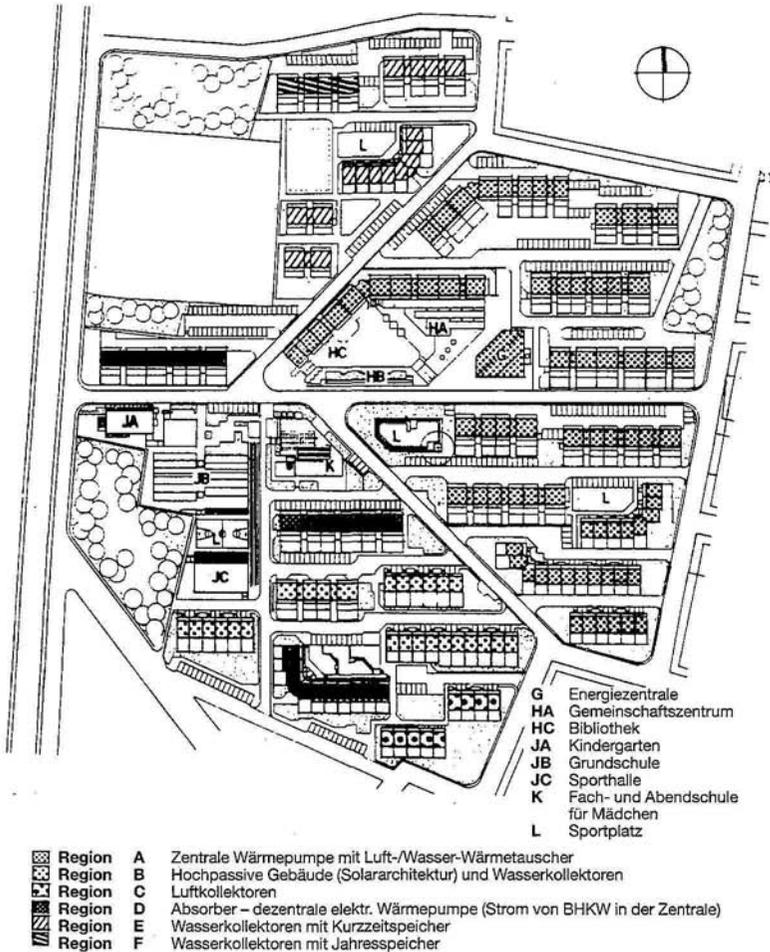
Abbildung 5: Verbindung zwischen Solarenergie und konventionellen Heizungssystemen
