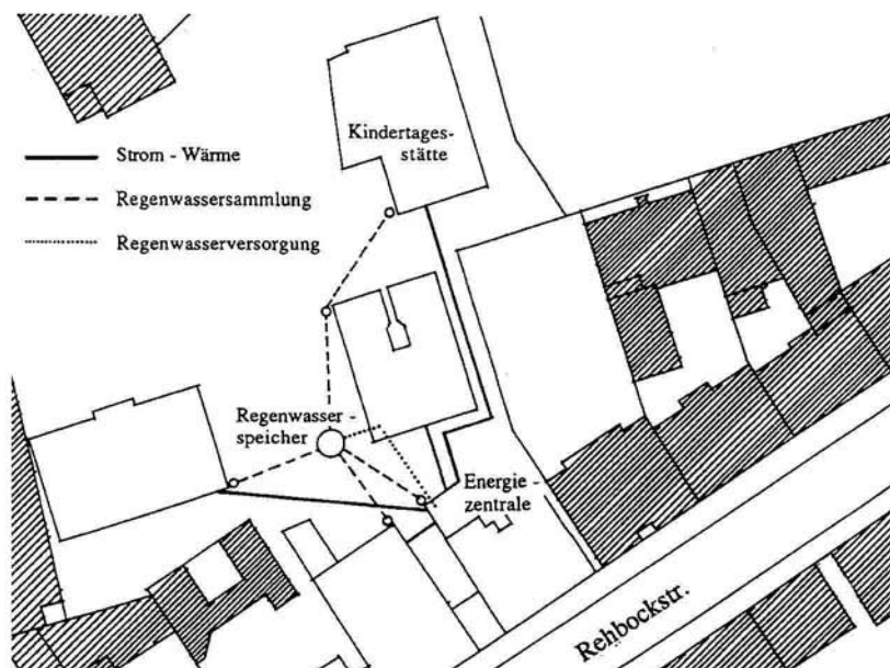
Abbildung 3: Regenwasserspeicher und Energiezentrale
