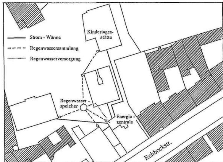
Abb. 9 Regenwassernutzungsanlage für 40 Wohneinheiten, Lageplan
